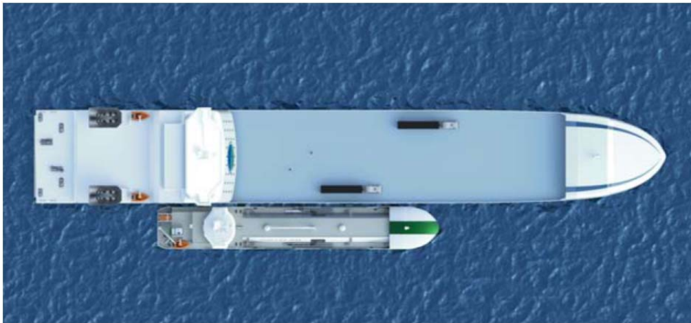
Kuva 7.2. Tavanomainen alusten kiinnitystapa LNG-bunkrauksessa (Swedish Marine Technology Forum).
