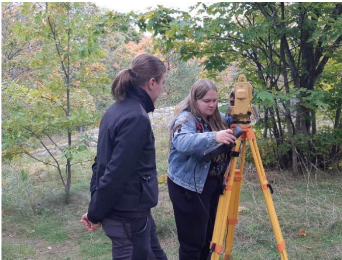
Kartoitusharjoitukset takymetrillä kuuluvat Kenttätökurssi 2 ohjelmaan. Kuva: Henrik Asplund.
