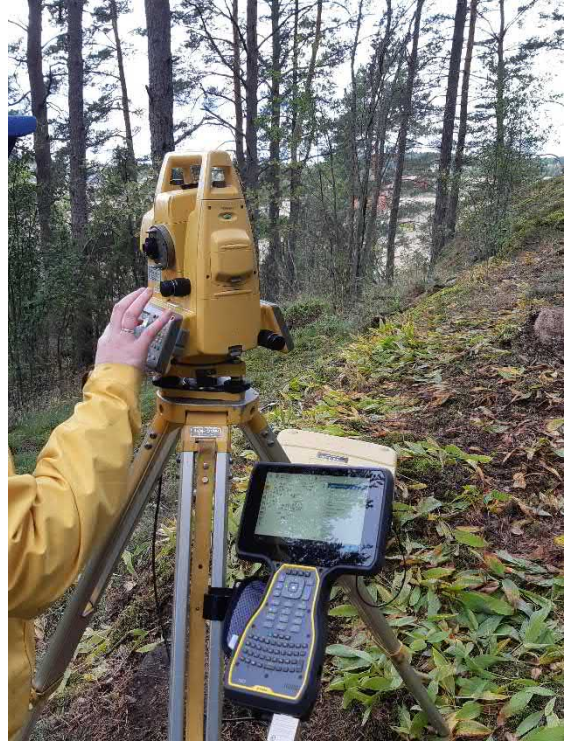
Vuoden 2019 Kenttätökurssilla 2 testattiin Liedon Pettisissä aiempaa suuremmalla näytöllä varustettua maastotallenninta yhdistettynä GPS-antenniin ja takymetriin. Kuva: Henrik Asplund.
